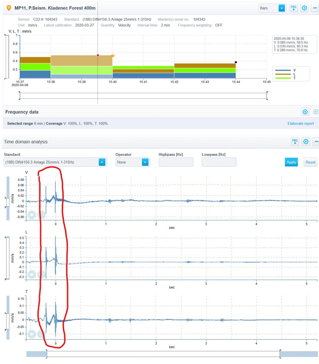
Σχήμα 1. Καταγεγραμμένα αποτελέσματα από τη μέτρηση της εκρηκτικής-σεισμικής επίδρασης με εξειδικευμένο εξοπλισμό στις 8 Απριλίου 2020.
